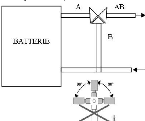
**3 WAYS VALVE MUST BE CONNECTED WHEN POWER IS OFF**
